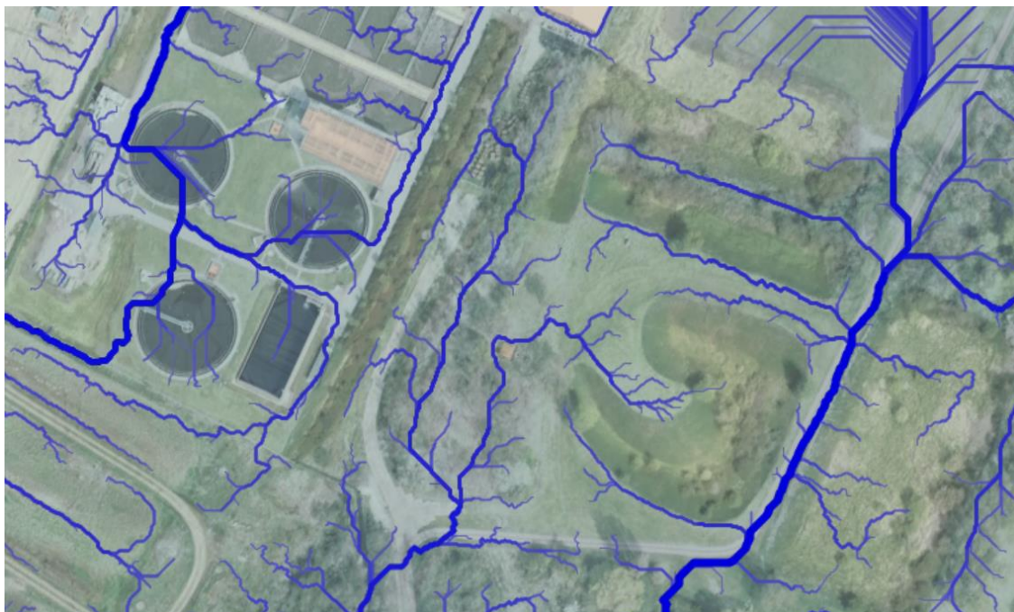
Figur 16-5. Kortet viser de overfladiske strømningssveje i ekstreme nedbørstilfælde hvor der sker overfladisk afstrømning, når jorden er vandmættet og eventuelle dræn er fyldte.
