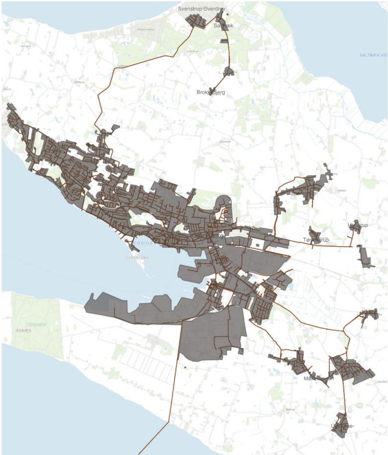
Figur 6: Kort der viser de kloakplande og transportledninger der er tilknyttet KCR.
