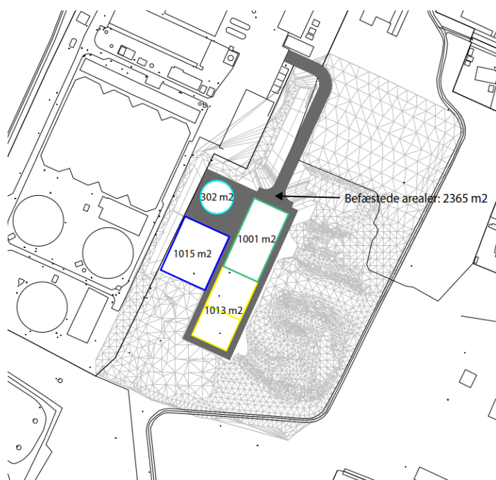
Figur 16-6. Befæstede arealer og tagarealer der etableres på grønne areal. De 302 m 2 viser en skylletank. De 1.013 m 2 viser sandfilteret. De 1.001 m 2 viser kulfilteret. De 1.015 m 2 viser et åbent bassin som ikke tages med i beregningen, da der ikke er afstømning fra tagareal.
