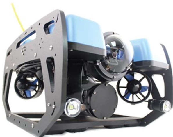
Figur 2-2. ROV af fabrikatet Blue ROV2, der vil blive brugt til de visuelle verifikationer.
