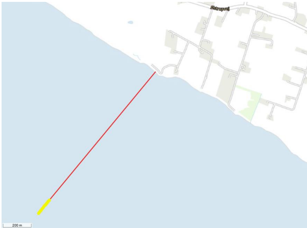
Figur 7a: Kort der viser blandingszonerne (gul markering) ved de 18x2 udløbspunkter i Jammerland Bugt.
