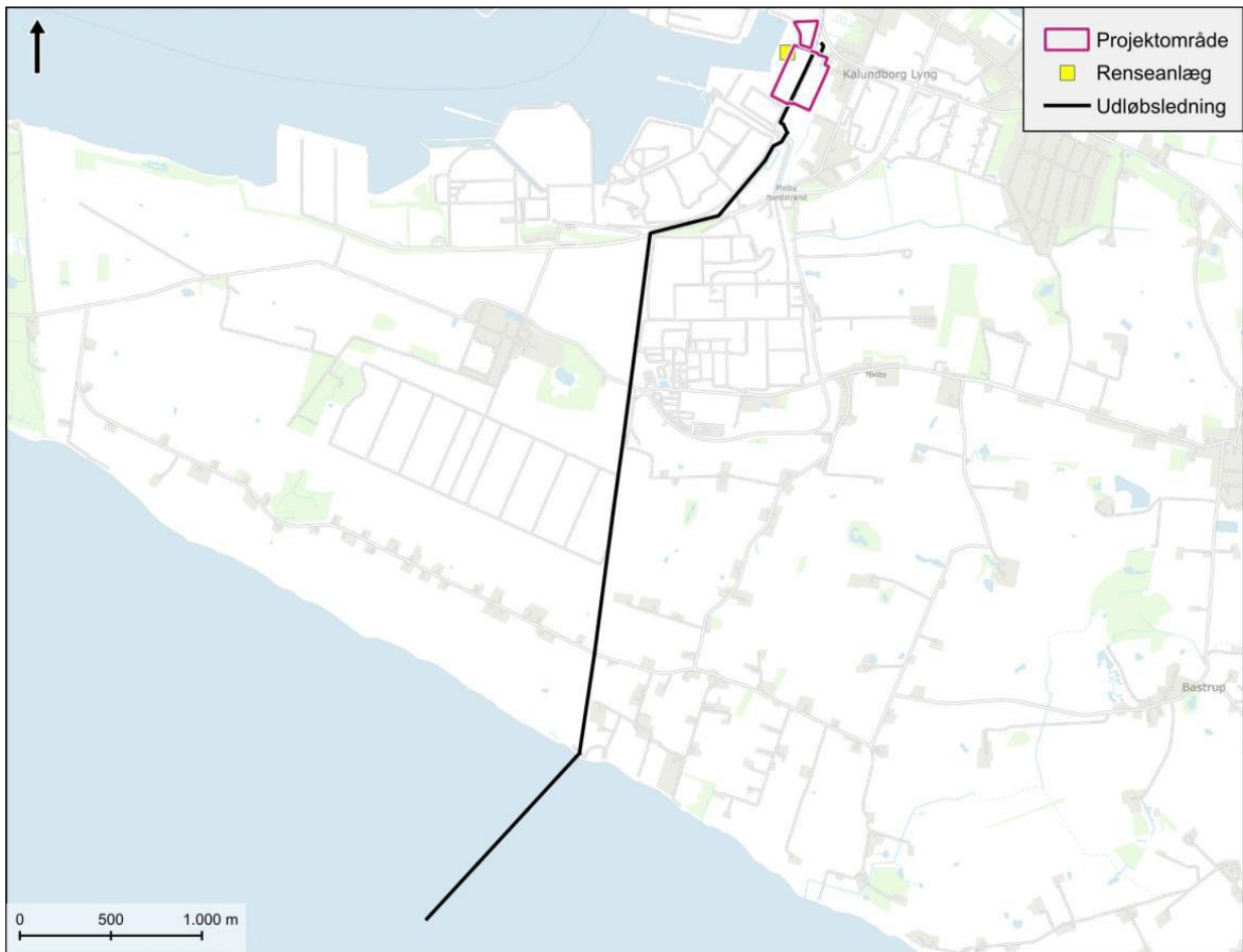
Figur 3: Eksisterende udløbsledning fra Kalundborg Centralrenseanlæg til udløbspunktet ca. 1.300 m fra kysten.
